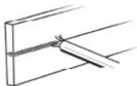
Рисунок 15. Горизонтальное положение при сварке
