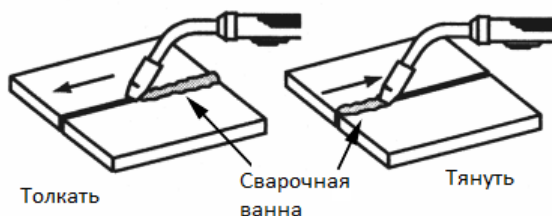
Рисунок 19. Направление движения горелки
