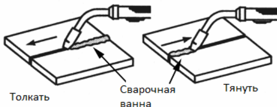
Рисунок 19. Направление движения горелки
