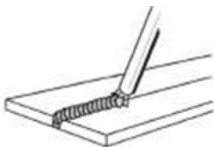
Рисунок 11. Нижнее положение при сварке
