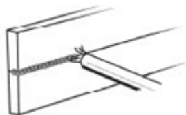
Рисунок 12. Горизонтальное положение при сварке
