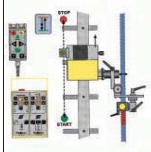
Система дополнена устройством выбора положения начала и конца сварки и возврата на заданную длину. Оснащена пультом дистанционного управления оригинальной конструкции, для сварки различных изделий.
