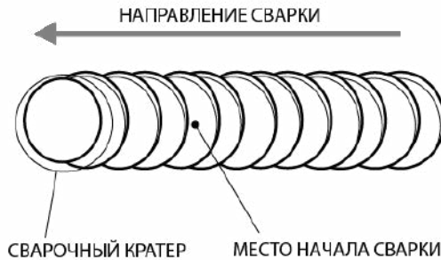
Рис. 11.2.2. Начало сварки при смене электрода.
