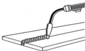
Рисунок 21. Сварка в нижнем положении
