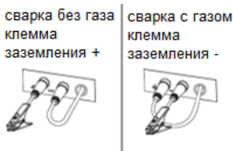
Рисунок 16. Полярность при полуавтоматической сварке
