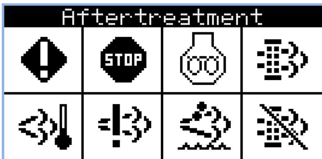
Изображение 5.39 Пример активных индикаторов на экране системы контроля отработавших газов
