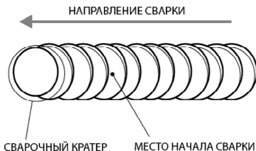
Рис. 11.4. Начало сварки при смене электрода.
