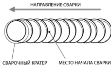
Рис. 11.2.2. Начало сварки при смене электрода.
