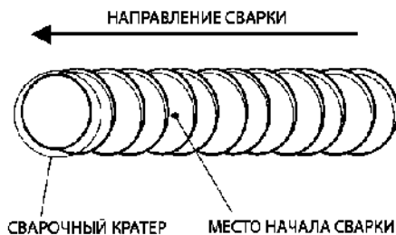
Рис. 11.4. Начало сварки при смене электрода.
