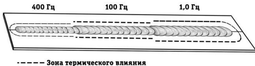
Рис. 9.22. Зависимость частоты импульса.
