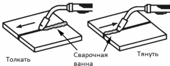
Рисунок 20. Направление движения горелки
