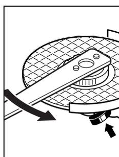
Правильно закрепленную, не имеющую повреждений быстрозажимную гайку Вы можете отвернуть, вращая рукой кольцо с накаткой против часовой стрелки. **Никогда не отворачивайте прочно сидящую быстрозажимную гайку клещами, а пользуйтесь ключом для гаек с двумя торцовыми отверстиями.** Накладывайте ключ для гаек с двумя торцовыми отверстиями согласно рисунку.
