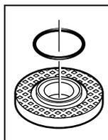
На опорном фланце 8 вокруг центрирующего буртика находится пластмассовая деталь (кольцо круглого сечения). Если кольцо круглого сечения отсутствует или повреждено, опорный фланец 8 необходимо обязательно заменить перед дальнейшим применением.
