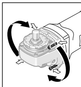
Можете да завъртите главата на редуктора на стъпки от по  $90^\circ$ . Така при специални работни условия пусковият прекъсвач може да бъде поставен в по-удобна позиция, напр. при рязане с използване на предпазния кожух с прахоулавяне и водеща шейна **19** или ако работите с лявата ръка.
