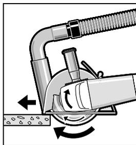
Elektrinį įrankį įjunkite ir kreipiamųjų pavažų priekine dalimi uždėkite ant ruošinio. Stumkite elektrinį įrankį pagal apdorojamą paviršių pritaikyta pastūma.
