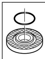
V upínací přírubě 8 je kolem středního osazení vložen díl z umělé hmoty (o-kroužek). Pokud o-kroužek chybí nebo je poškozen, musí být před dalším používáním upínací příruba 8 bezpodmínečně vyměněna.
