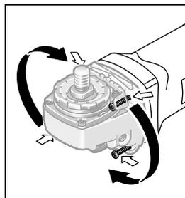
Редукторная головка может поворачиваться с интервалом в 90°. Таким образом выключатель может быть установлен в удобное для работы положение, например, для отрезных работ с вытяжным колпаком и направляющими салазками **19** или для левши.
