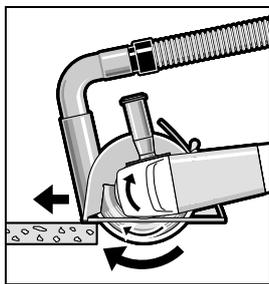
Вклучете го електричниот апарат и поставете го со предниот дел на лизгачките водилки на делот што се обработува. Поместувајте го електричниот апарат со умерено движење по материјалот што се обработува.
