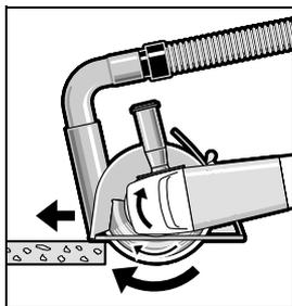
Włączyć elektronarzędzie i przyłożyć przednią część prowadnicy do ciętego elementu. Pracować z równomiernym, optymalnie dopasowanym do danego typu materiału posuwem.
