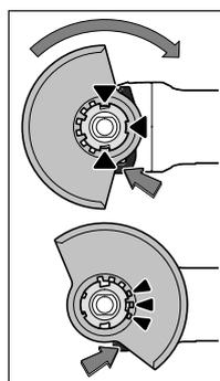
Należy osłone tarczy **7** na kołnierzu wrzeciona urządzenia w ten sposób, aby występy (zęby) ustalające osłony pokryły się z kołnierzem wrzeciona. Należy przy tym pociągnąć i przytrzymać dźwignię **1**.
