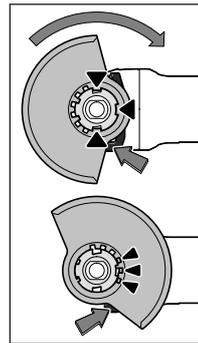
Tegye fel a 7 védőbúrát az elektromos kéziszerszámon a megfelelő helyre, amíg a védőbúra kódolóbütykei egybe nem esnek a rögzítő egység megfelelő bemélyedéseivel. Nyomja le és tartsa lenyomva az 1 reteszelésfeloldó kart.
