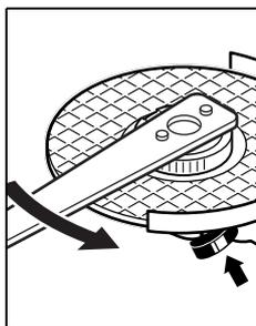
Řádně upevněnou, nepoškozenou rychloupínací matici můžete uvolnit rukou otáčecím rýhovaným kroužkem proti směru hodinových ručiček. **Pevně usazenou rychloupínací matici nikdy neuvolňujte pomocí kleští, nýbrž použijte klíč se dvěma čepý.** Klíč se dvěma čepý nasadte jak je zobrazeno na obrázku.
