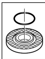
În flanșa de prindere **8**, în jurul gulerului de centrare este montată o piesă din plastic (garnitură inelară). **În cazul în care garnitura inelară lipsește sau este deteriorată, flanșa de prindere 8 trebuie neapărat înlocuită înainte de reutilizare.**
