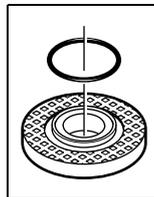
На центровачщото стъпало на фланеца **8** е поставен уплътнителен елемент (O-пръстен). **Ако O-пръстенът липсва или е повреден**, преди използване на електроинструмента центровачният фланец **8** трябва задължително да бъде заменен.
