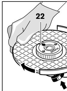
A csiszolótengely rögzítéséhez nyomja meg a 2 tengelyrögzítógombot. A gyorsbefogó anya megszorításához fordítsa el a csiszolótárcsát erőteljesen az óramutató járásával megegyező irányban.
