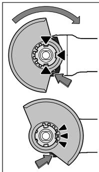
Uždėkite apsauginį gaubtą 7 ant elektrinio įrankio laikiklio, kad apsauginio gaubto kodiniai kumšteliai sutaptų su laikikliu. Tuo metu spauskite ir laikykite paspaustą atblokavimo svirtelę 1.
