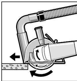
Ieslēdziet elektroinstrumentu un novietojiet vadotnes priekšējo daļu uz griežamā priekšmeta. Vienmērīgi virziet elektroinstrumentu pa griežamo priekšmetu ar mērenu ātrumu, kas atbilst griežamā materiāla īpašībām.
