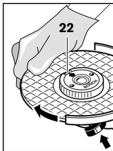
Ustalić położenie wrzeciona za pomocą przycisku blokady **2**. Nakrętkę szybkomocującą dociągnąć, mocno przekręcając tarczę szlifierską w kierunku zgodnym z ruchem wskazówek zegara.
