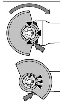
Надіньте захисний кожух для шліфування **7** на посадочне місце на електроприладі, щоб кодовані кулачки захисного кожуха співпадали з посадочним місцем. При цьому натисніть і тримайте натиснутим розблокувальний важіль **1**.
