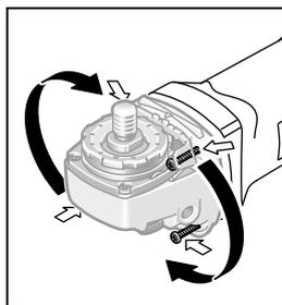
Glavu prijenosnika možete zakrenuti u koracima do 90°. Na taj se način prekidač za uključivanje/isključivanje može prebaciti u povoljniji položaj rukovanja za posebne slučajeve primjene, npr. za radove rezanja sa usisnom haubom sa vodilicama 19 ili za ljevake.
