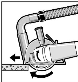
Elektronářadí zapněte a posadte jej předním dílem vodicích saní na obrobek. Elektronářadí posouvajte s mírným, opravovanému materiálu přizpůsobeným posuvem.
