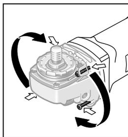
Možete glavu prenosnika okretati u 90° podeoka. Na taj način se prekidač za uključivanje-isključivanje za posebne radne slučajeve dovodi u povoljniju poziciju za rukovanje, na primer za radove presecanja sa usisavajućom haubom sa klizajućom vodjicom **19** ili za levoruke.
