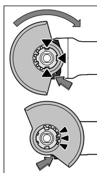
Stavite zaštitnu haubu **7** na prihvat na električnom alatu, da kodni ispusti zaštitne haube budu usaglašeni sa prihvatom. Pritisnite i držite pritom polugu za deblokadu **1**.
