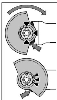
Potrivii astfel apărătoarea de protecție **7** pe sistemul de prindere al accesoriilor, încât camele de codificare ale apărătoarei de protecție să fie în concordanță cu cele ale sistemului de prindere. Apăsăți și mențineți apăsată în acest scop pârghia de deblocare **1**.
