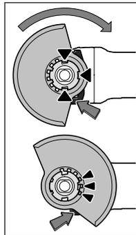
Novietojiet aizsargpārsegu **7** uz elektroinstrumenta darbvirsmas aptveres tā, lai kodējošie izciļņi sakristu ar gropēm aptverē. Nospiediet un turiet nospiešanu fiksējošo sviru **1**.
