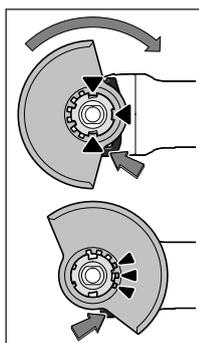
Ochranný kryt 7 položte na upínací místo na elektronářadí tak, až kódovací výstupky ochranného krytu souhlasí s upínacím místem. Přitom stlačte a podržte odjišťovací páčku 1.
