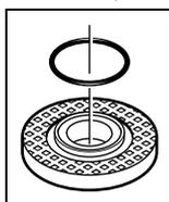
Balstaplāksnes 8 centrējošo izcilni aptver plastmasas detaļa (O veida gredzens). **Ja O veida gredzens trūkst vai arī tas ir bojāts, balstaplāksne 8 pirms instrumenta tālākas lietošanas noteikti jānomaina.**
