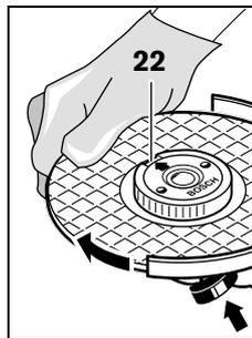
Натисніть на фіксатор шпинделя **2**, щоб зупинити шліфувальний шпindel. Для затягнення швидкозатискної гайки з силою поверніть шліфувальний круг за стрілкою годинника.
