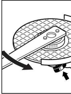
Egy előírászerűen rögzített hibátlan gyorsbefogó anyát a recézett gyűrűnek az óramutató járásával ellentétes irányba való elforgatásával kézzel ki lehet lazítani.
