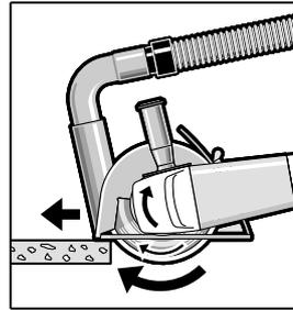
Uključite električni alat i stavite ga na izradak sa prednjim dijelom vodilica. Pomičite električni alat sa umjerenim posmakom prilagođenim obrađivanom materijalu.
