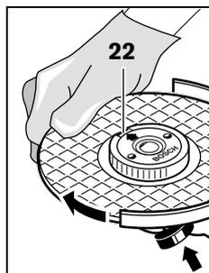
Для фиксации шлифовального шпинделя нажмите кнопку фиксирования шпинделя **2**. Для затягивания быстрозажимной гайки поверните шлифовальный круг с усилием по часовой стрелке.
