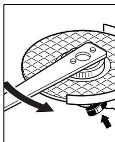
Puteți slăbi o piuliță de strângere rapidă fixată corespunzător, nedeteriorată, rotind cu mâna, în sens contrar mișcării acelor de ceasornic, inelul zimțat.
