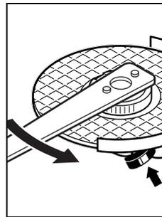
Дұрыс бекітілген, зақымдалмаған тез қысқыш гайканы сақинаны сағат тіліне кері буру арқылы бұра алуға болады. **Ешқашан қатты бекемделген тез қысқыш гайканы тістеуімен бұрап алмаңыз, екі бүйірлік тесігі бар гайка кілтін пайдаланыңыз.** Гайка кілтін суретте көрсетілгендей екі бүйірлік тесігімен орнатыңыз.
