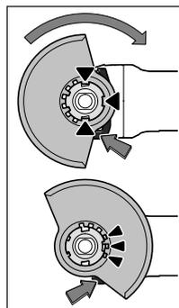
Установите защитный кожух **7** на посадочную поверхность электроинструмента так, чтобы кулачки кодирования кожуха совпали с посадочной поверхностью. Нажмите и держите при этом рычаг разблокировки **1**.
