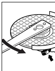
Затегната правилно, неповредена гайка за бързо застопоряване може да бъде развита чрез завъртане на ръка на накатения пръстен в посока, обратна на часовниковата стрелка.
