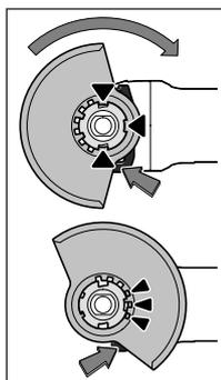
Stavite štitnik **7** na stezač na električnom alatu, sve dok se kodirni izdanak štitnika ne poklopi sa stezačem. Kod toga pritisnite i držite pritisnutu polugu za deblokiranje **1**.
