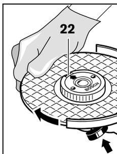
Pritisnite taster za blokadu vretena **2** da bi utvrdili brusno vreteno. Da bi stegli navrtku sa brzim zatezanjem, okrenite brusnu ploču snažno u pravcu kazaljke na satu.
