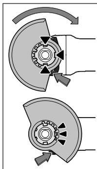
Ставете ја заштитната хауба **7** на прифатот од електричниот апарат, додека кодираните запци на заштитната хауба не се поклопат со прифатот. Притоа, притиснете го и држете го лостот за отклучување **1**.
