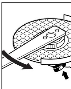
Propisno pričvršćenu neoštećenu brzostežuću maticu možete otpustiti okretanjem nareckanog prstena u smjeru suprotnom od kazaljke na satu.
