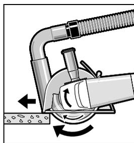
Включите электроинструмент и установите его передней частью направляющих салазок на деталь. Переключите электроинструмент с умеренной, соответствующей обрабатываемому материалу подачи.
