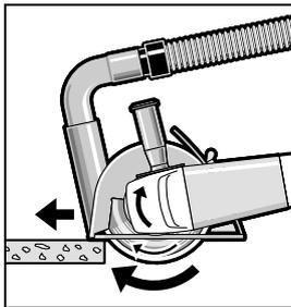
Kapcsolja be az elektromos kéziszerszámot és helyezze fel a vezetősánnal első részével a megmunkálásra kerülő munkadarabra. Az elektromos kéziszerszámot a megmunkálásra kerülő anyagnak megfelelő mérsékelt előtolással mozgassa előre.
