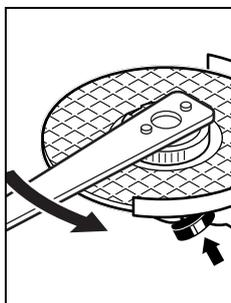
Prawidłowo zamocowana, nieuszkodzona nakrętka mocująca pozwala się łatwo poluzować ręką, poprzez obracanie pierścieniem radełkowym w kierunku przeciwnym do ruchu wskazówek zegara. **Mocno dokręconej nakrętki nie zwalniać nigdy za pomocą szczypiec lub kombinerek. Stosować wyłącznie klucz dwutrzipieniowy.** Klucz nasadzać, jak pokazano na rysunku.
