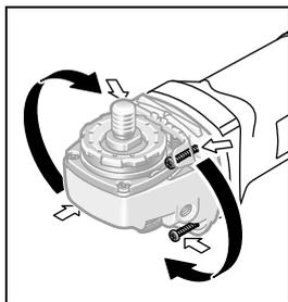
Погонската глава може да ја вртите на 90°-нивоа. Притоа, прекинувачот за исклучување/вклучување може да се постави во поповолна позиција при изведување на посебни случаи на работа, на пр. сечење со хауба за вшмукување со лизгачка водилка **19** или за левораки лица.
