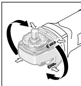
Prevodovú hlavu môžete otáčať po krokoch v hodnote  $90^\circ$  stupňov. Takýmto spôsobom si môžete v špeciálnych prípadoch nastaviť vypínač do výhodnejšej polohy, napríklad pri rezaní s odsávacím krytom pomocou vodiacich saní **19**, alebo ak ste ľavákom.
