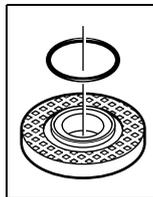
V upínacej prírubke 8 je okolo centrovačieho nástavca vložený element z plastu (okružla podložka). Ak táto okrúhla podložka chýba, alebo ak je poškodená, upínaciu prírubu 8 treba pred ďalším používaním bezpodmienečne vymeniť za novú.
