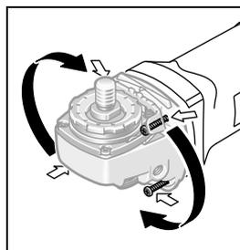
Elektroinstrumenta pārnesuma galva ir pagriežama ar soli  $90^\circ$ . Tas spēj atvieglot darbu īpašās situācijās, jo lietotājam ir iespēja izvēlēties izdevīgāko ieslēdzēja novietojumu, piemēram, darbinot elektroinstrumentu kopā ar griešanas aizsargpārsegu ar putekļu uzsūkšanu un griešanas vadotni **19**, kā arī gadījumos, ja elektroinstrumentu lieto kreilis.
