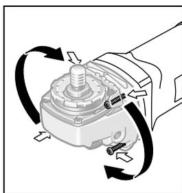
Głowica przekładni obracana jest w czterech skokach (co  $90^\circ$ ). Pozwala to na ustawienie włącznika/wyłącznika w wygodniejszej pozycji roboczej w przypadku specyficznych zastosowań, np. podczas cięcia przy użyciu pokrywy odsysającej z przewodniczą saneczkową 19, a także dla osób leworęcznych.
