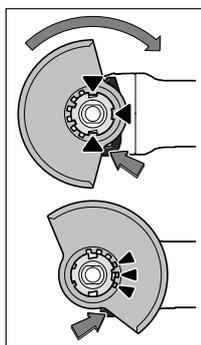
Položite zaščitni pokrov **7** na prijemalo na električnem orodju, tako da se kodirni utori zaščitnega pokrova ujemajo s prijemalom. Pri tem pritisnite in držite deblokirno ročico **1**.
