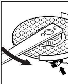
Správne upevnená a nepoškodená rýchloupínacia matica sa dá uvoľniť rukou otočením ryhovaného prstenca proti smeru pohybu hodinových ručičiek.
