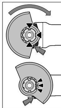
Поставете предпазния кожух **7** на захващащото стъпало на електроинструмента така, че кодиращите гърбици да съвпадат с каналите на стъпалото. При това натиснете и задръжте освобождаващия лост **1**.
