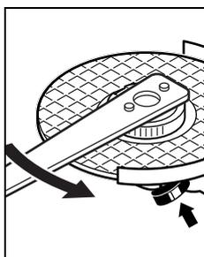
Jednu propisno učvršćenu, neoštećenju navrtku sa brzim zatezanjem možete rukom odvrnuti okretanjem nareckanog prstena nasuprot smeru kazaljke na satu. **Ne odvrćite čvrsto stegnutu navrtku sa brzim zatezanjem sa kleštama, već koristite ključ sa dva otvora.** Upotrebjavajte ključ kao što slika pokazuje.
