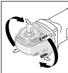
Головку редуктора можна повертати з інтервалом у 90°. Завдяки цьому вимикач буде знаходитися у більш зручному для певних видів роботи положенні, напр., при розрізанні з витяжним ковпаком з люнетним супортом **19** або якщо Ви лівша.
