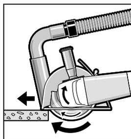
Vklopite električno orodje in ga s sprednjim delom drsnega vodila postavite na obdelovanec. Električno orodje pomikajte z zmernim pomikom, ki ga morate prilagoditi materialu, ki ga obdelujete.
