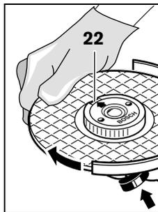
Lai nekustīgi nostiprinātu elektroinstrumenta darbvārpstu, nospiediet darbvārpstas fiksēšanas taustiņu 2. Lai pieskrūvētu rokas piespiedējuzgriezni, spēcīgi grieziet slīpēšanas disku pulksteņa rādītāju kustības virzienā.
