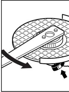
Закріплену належним чином, непошкоджену швидкозатискну гайку можна відпустити, вручну повертаючи кільце з накаткою проти стрілки годинника.
