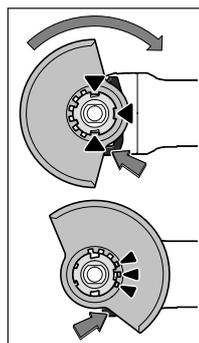
Priložte ochranný kryt **7** na držiak na ručnom elektrickom náradí tak, aby sa kódovacie výstupky ochranného krytu zhodovali s kódovacími prvkami držiaka. Stlačte a podržte stlačenú uvoľňovaciu páku **1**.
