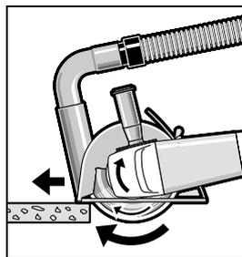
Включете електроинструмента и поставете предната част на направляващата шейна върху детайла. Придвижвайте електроинструмента с умерено, съобразено с обработвания материал подаване.
