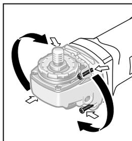
Hlavu převodovky můžete otočit v krocích po 90°. Tím lze uvést spínač pro zvláštní případy práce do výhodnější manipulační polohy, např. pro dělicí práce s odsávacím krytem s dělicími saněmi 19 nebo pro leváky.
