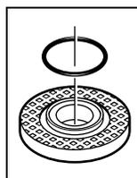
U steznoj pribornici **8** oko naslona za centriranje ugrađen je plastični dio (O-prsten). **Ako O-prsten nedostaje ili je oštećen**, prije daljnje primjene, stezna pribornica **8** se mora neizostavno zamijeniti.
