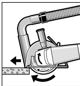
Porneți scula electrică și puneți-o cu partea anterioară a saniei de ghidare pe piesa de lucru. Împingeți scula electrică cu avans moderat, adaptat materialului de prelucrat.
