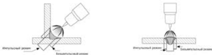
Рис. 8.7. Выделяемое тепло в импульсном и безимпульсном режимах.
