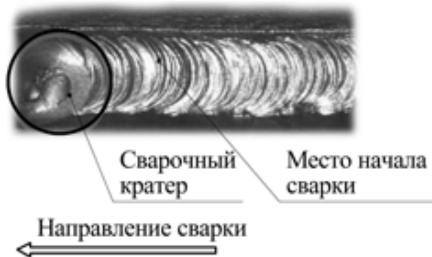
Рис. 9.4. Начало сварки при смене электрода.
