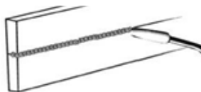
Рисунок 22. Сварка в горизонтальном положении
