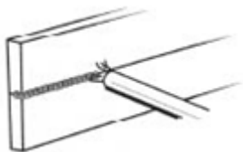
Рисунок 15. Горизонтальное положение при сварке
