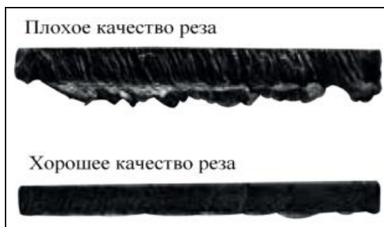
Рис.4 Влияние силы тока и скорости реза.
