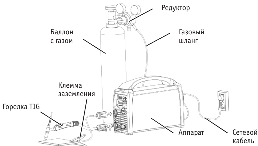
Рис. 8.1. Схема подключения оборудования.
