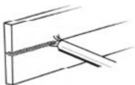
Рисунок 19. Горизонтальное положение при сварке
