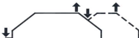
Рисунок 4. 2х тактный режим работы горелки
