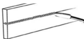
Рисунок 22. Сварка в горизонтальном положении
