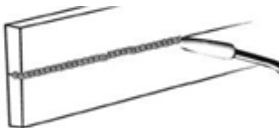
Рисунок 17. Сварка в горизонтальном положении
