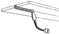
Рисунок 18. Сварка в потолочном положении
