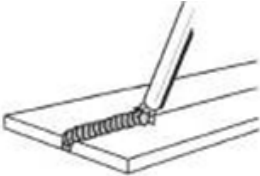
Рисунок 9. Нижнее положение при сварке
