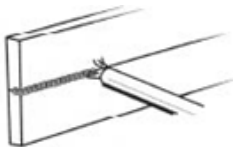
Рисунок 10. Горизонтальное положение при сварке
