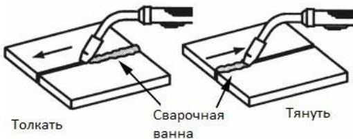
Рисунок 14. Направление движения горелки
