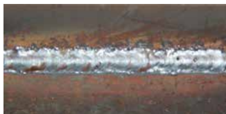
Рис 9.1. Сварной шов при минимальном значении индуктивности.
