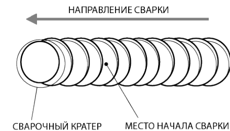
Рис. 9.4. Начало сварки при смене электрода.
