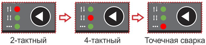
Рисунок 10-7 Выбор режима сварки
