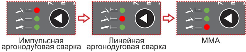
Рисунок 10-6. Выбор режима сварки.
