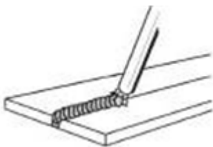
Рисунок 18. Нижнее положение при сварке
