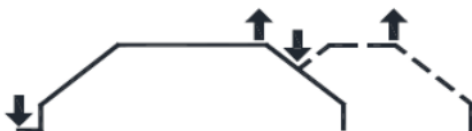
Рисунок 4. 2х тактный режим работы горелки
