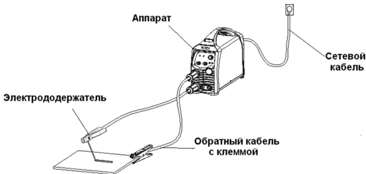
Рисунок 6.3 Схема подключения оборудования для ММА сварки.
