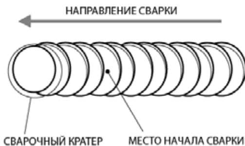
Рис. 13.5. Начало сварки при смене электрода.
