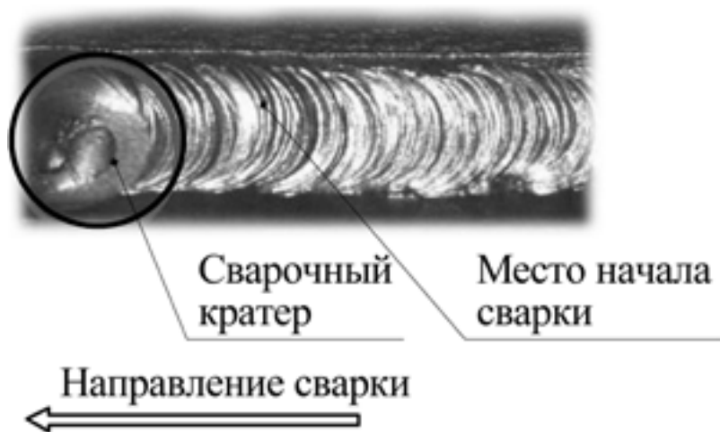
Рис. 9.4. Начало сварки при смене электрода.
