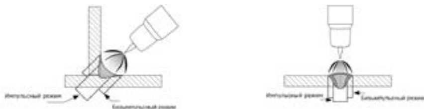
Рис. 8.10. Выделяемое тепло в импульсном и безимпульсном режимах.
