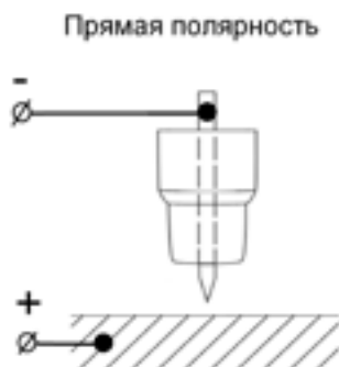
Рис. 8.6. Полярность при TIG сварке.
