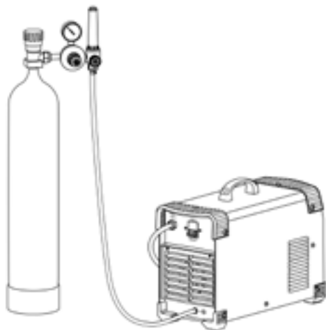
Рис. 8.3. Подключение защитного газа.
