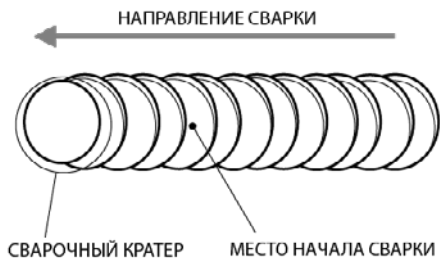
Рис. 10.4. Начало сварки при смене электрода.
