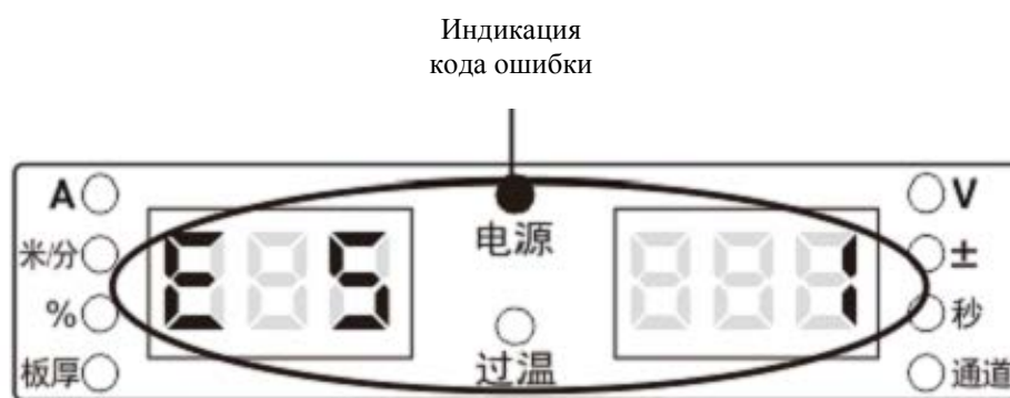
Рисунок 4-1. Отображение кода ошибки на панели управления сварочного источника питания
